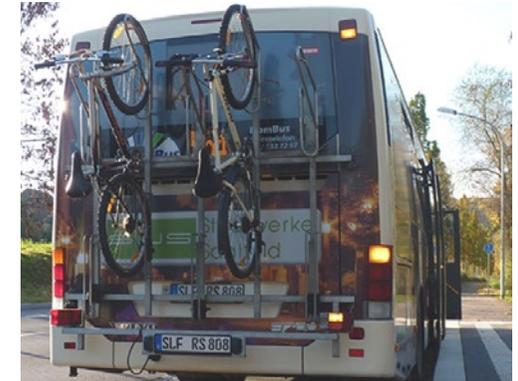
Abb. 2.70: KomBus mit Fahrradheckträger.
